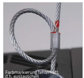
Farbmarkierung fehlerhaft, d.h. austauschen
