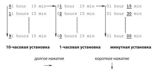
Активируйте таймер, выйдя из меню настроек с помощью долгого нажатия кнопки. В качестве альтернативы обратный отсчёт запускается автоматически, если не изменять имеющиеся настройки более 12 секунд.
