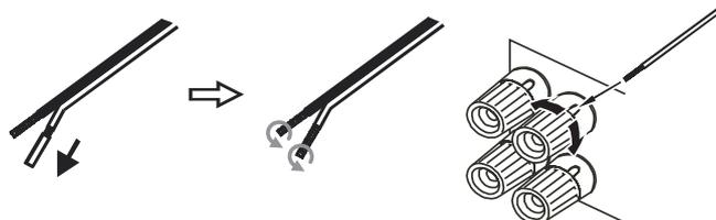
Для непосредственного подключения к контактам акустических систем рекомендуется использовать штекеры типа «банан» (стандартные, 4 мм), подключенные к кабелю акустических систем.
