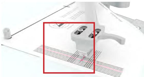
Abb. 13: Korrekte Ausrichtung des Tonabnehmers
