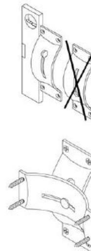
Выберите место для монтажа колонок и сделайте на стене отметки по краям более длинной скобы. Также отметьте на стене расположение отверстий, перед этим проверив их уровнем.
