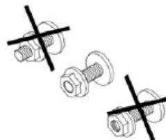
Проденьте винт через отверстие в более короткой изогнутой скобе, наденьте шайбу и завинтите гайку, как показано на рисунке. Просверлите отверстия и прикрепите скобу к корпусу колонки. Диаметр отверстий – 3 мм, глубина не более 15 мм во избежание проникновения шурупов внутрь корпуса.
