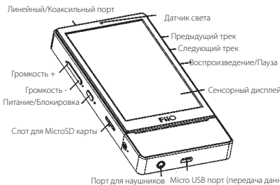
Порт для наушников Микро USB порт (передача данных/зарядка/подключение к док станции) 1
