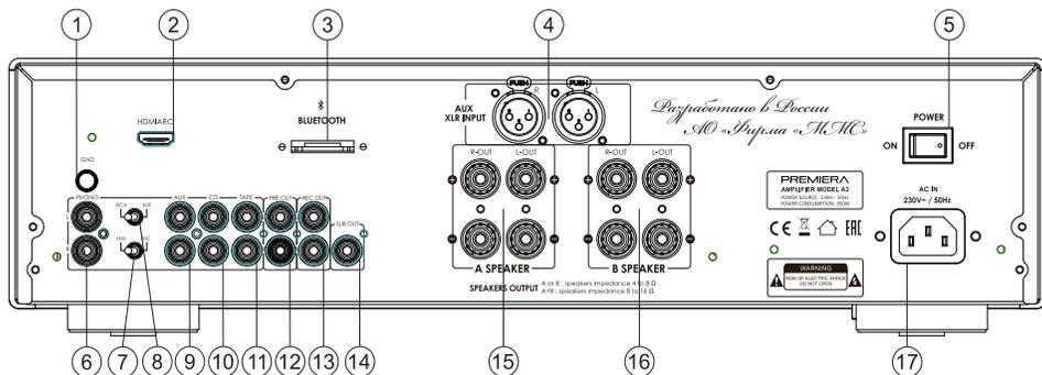
1. Клемма корпусного заземления
