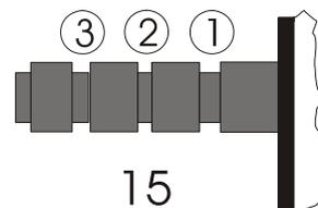
Перекиньте петлю подвески груза антискейтинга через канавку на направляющей (15), соответствующую прижимной силе, установленной для Вашего звукоснимателя, и пропустите нить через проволочную петлю суппорта (17).
