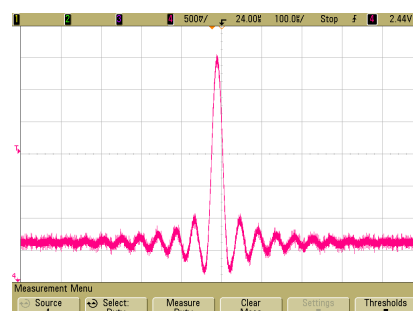
Импульсная характеристика цифрового фильтра FIR устройства CAS192D
