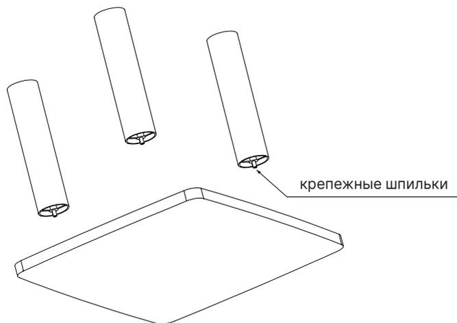
4. Вверните стойки в крепежные узлы верхней полки.
