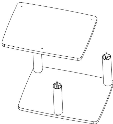
8. Шпильки должны выступать над поверхностью полки примерно на 20мм.
