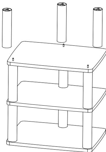
14. Вверните шпильки в стойки.
