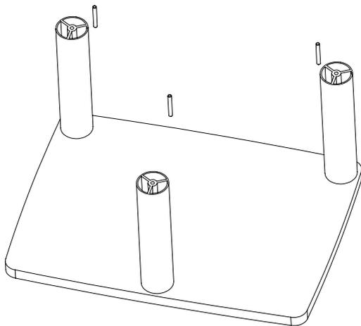
6. шпильки должны выступать из стоек примерно на 45мм.
