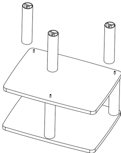
10. Вверните шпильки в стойки.
