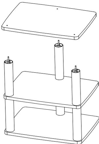
12. Вверните шпильки в стойки.
