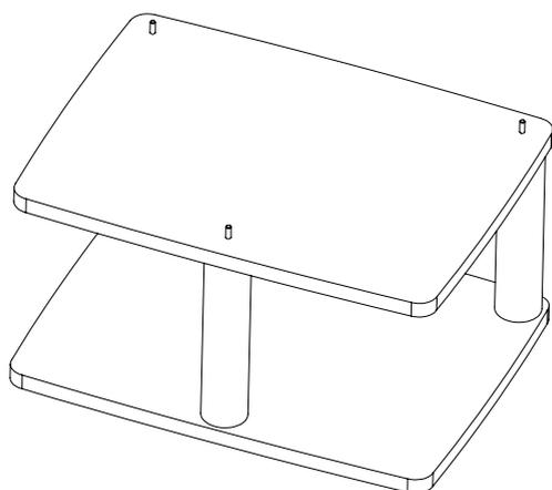
9. Плотно наверните стойки на выступающие шпильки.
