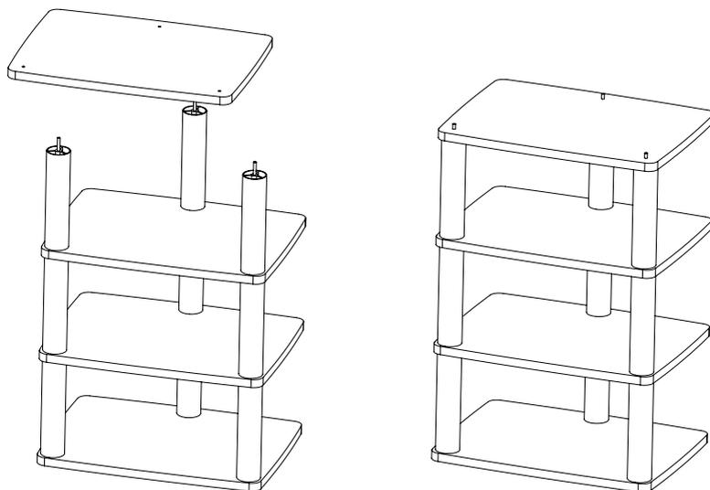
16. Установите нижние стойки на шпильки.
