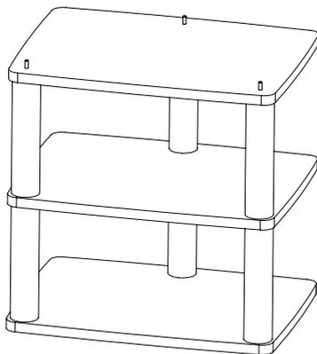
13. Плотно наверните стойки на выступающие шпильки.
