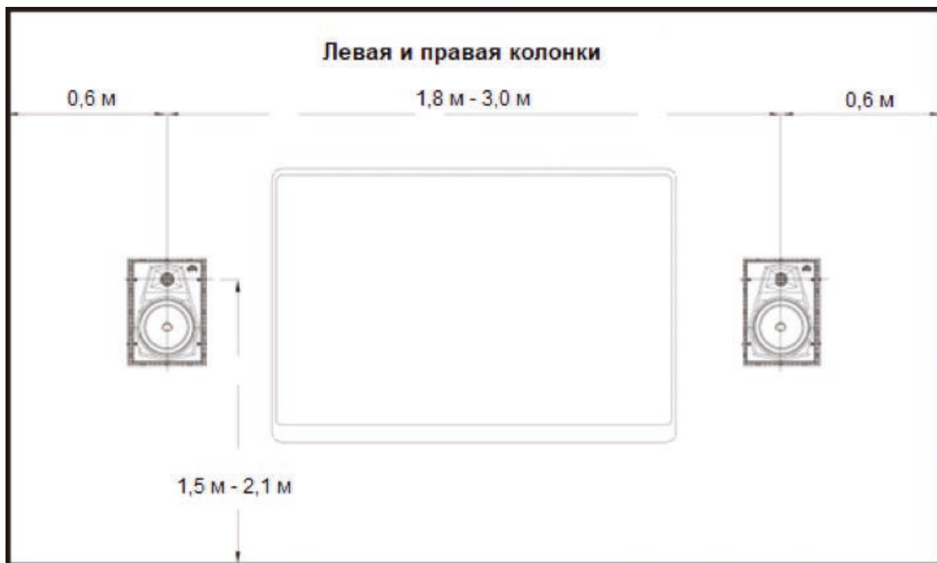
Рис. 5. Схема расположения АС в стереосистеме
