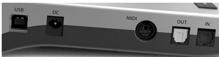
В левой части Babyface Pro находятся оптический вход и выход, разъём питания, гнездо USB и гнездо MINI DIN с 6 контактами для подключения MIDI кабеля.
