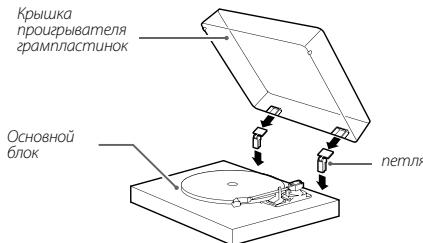
**1** Вставьте петли полностью в держатели слева и справа на задней панели основного блока.
