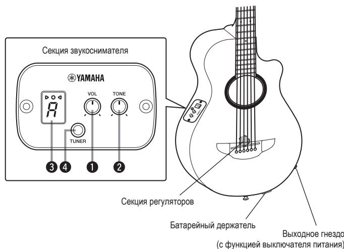
**При подсоединении кабеля гитары к выходному гнезду автоматически включается встроенный предусилитель.**
