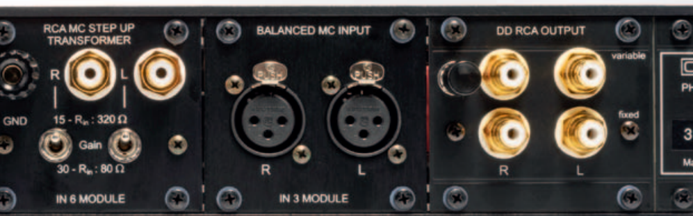
Ein „Fixed“-Ausgang mit Festpegel und ein Ausgang mit Pegelsteller erlauben den Anschluss an übliche Vor- oder Vollverstärker oder Direktanschluss an eine Endstufe.
