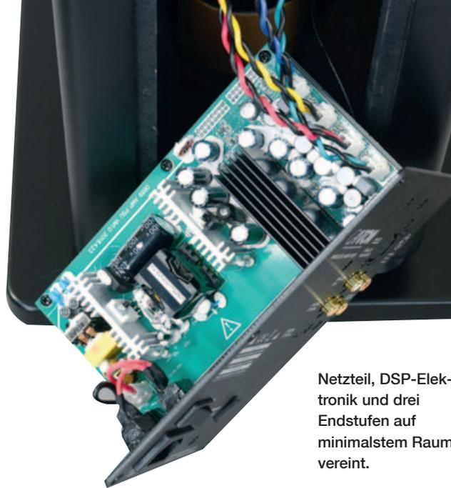
Netzteil, DSP-Elektronik und drei Endstufen auf minimalstem Raum vereint.
